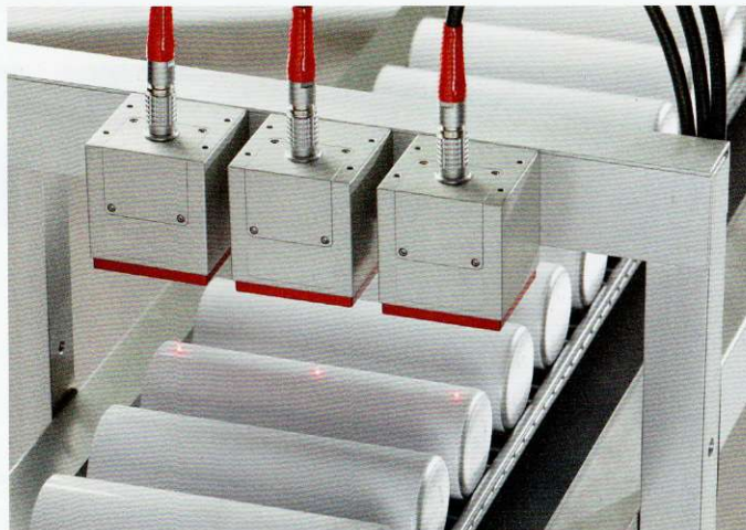
Bei der automatischen Schichtdickenmessung ist es wichtig, die richtigen Stellen auszuwählen
